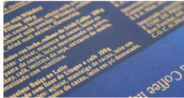
Beispiel eines hochauflösenden Golddrucks mit nyloflex® Gold A 116 D
